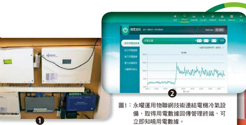
圖1：永曜運用物聯網技術連結電機冷氣設備，取得用電數據回傳管理終端，可立即知曉用電數據。
